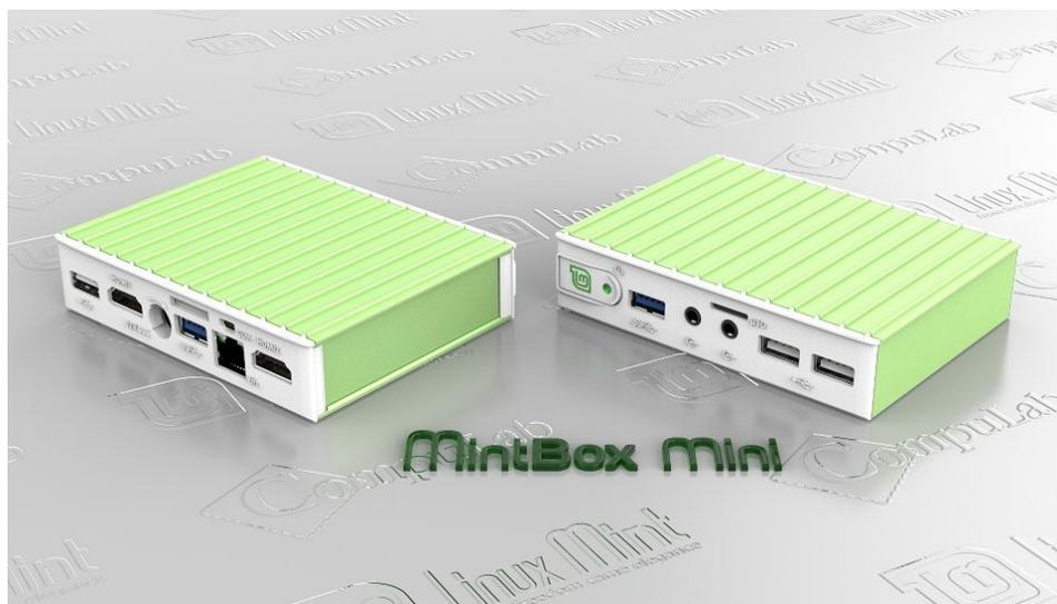
Устройство поставляется с 4-ядерным процессором AMD A4 6400T (1 ГГц), GPU Radeon R3, 4 Гб памяти, 64 Гб SSD, W-Fi, гигабитным Ethernet, 5 портами USB, картридером MicroSD и двумя разъемами HDMI. Цена компьютера – \$295.
