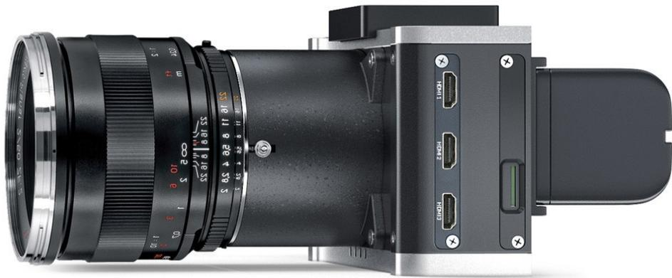
AXIOM Beta – компактная RAW-камера с байонетом Canon EF, оптическим стабилизатором и тремя HDMI-выходами (каждый – 1080p при 60 fps). Их можно использовать для одновременного вывода картинки с тремя различными режимами цветокоррекции, либо для вывода на различные устройства – например, рекордер и внешний видоискатель.
