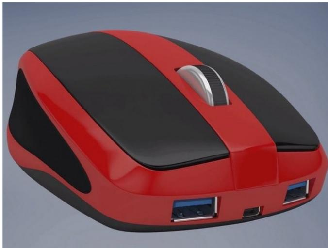
Интересную разработку представила группа польских инженеров – это мини-компьютер Mouse-Vox, совмещенный с мышью. Вместо шнура для соединения мыши с компьютером, в Mouse-Vox присутствует порт micro-HDMI, через который можно быстро организовать вывод через монитор, проектор или телевизор. Для подключения клавиатуры и периферии предусмотрено несколько портов USB.
